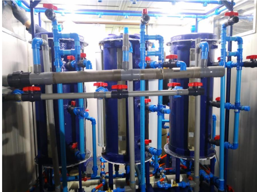
Figura 9. Sistema de fotobiorreactores en modo continuo en línea RAS de cultivo de salmónidos.
