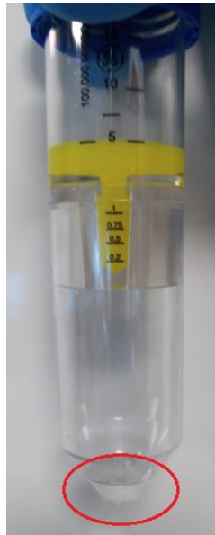
Figura 60. Tubo concentrador cargado con nanoemulsión doble post-centrifugación. En rojo se destaca líquido permeado.
